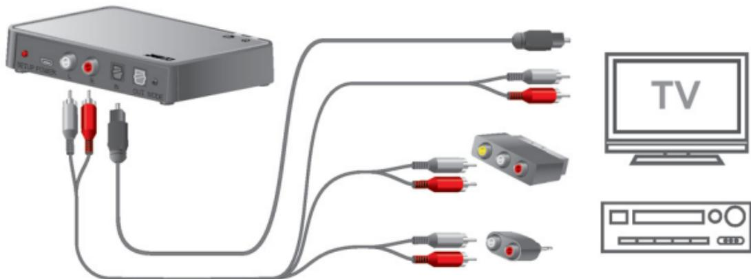
Wir empfehlen, **entweder** den TOSLINK-Eingang **oder** den Cinch-Eingang des Transmitters zu verwenden.
