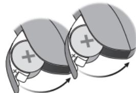
3. Schalten Sie beide Hörsysteme **EIN** (schließen Sie dazu das Batteriefach und warten Sie etwa 10 Sekunden).
