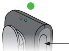
5. Schalten Sie den ConnectClip **EIN**. Halten Sie den Multifunktionsstaster ca. 3 Sekunden lang gedrückt, bis die Power-Anzeige **KONSTANT GRÜN leuchtet**. ●
